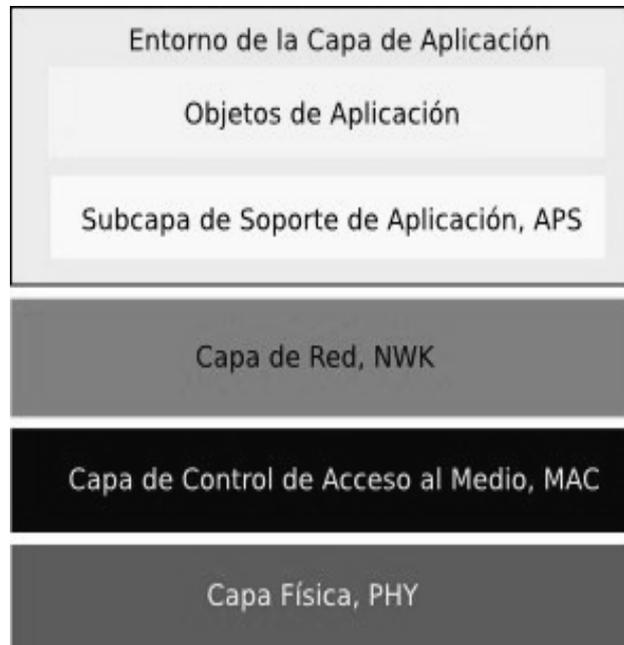
**Fig. 1: Arquitectura en capas del ZigBee/IEEE 802.15.4**
