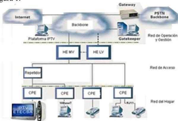
**Figura 1. Interconexiones de la Red de Acceso PLC.** Sin embargo también es posible el empleo de las Redes de media tensión, propiedad de las empresas eléctricas, para llevar la señal desde los puntos de distribución hasta los
