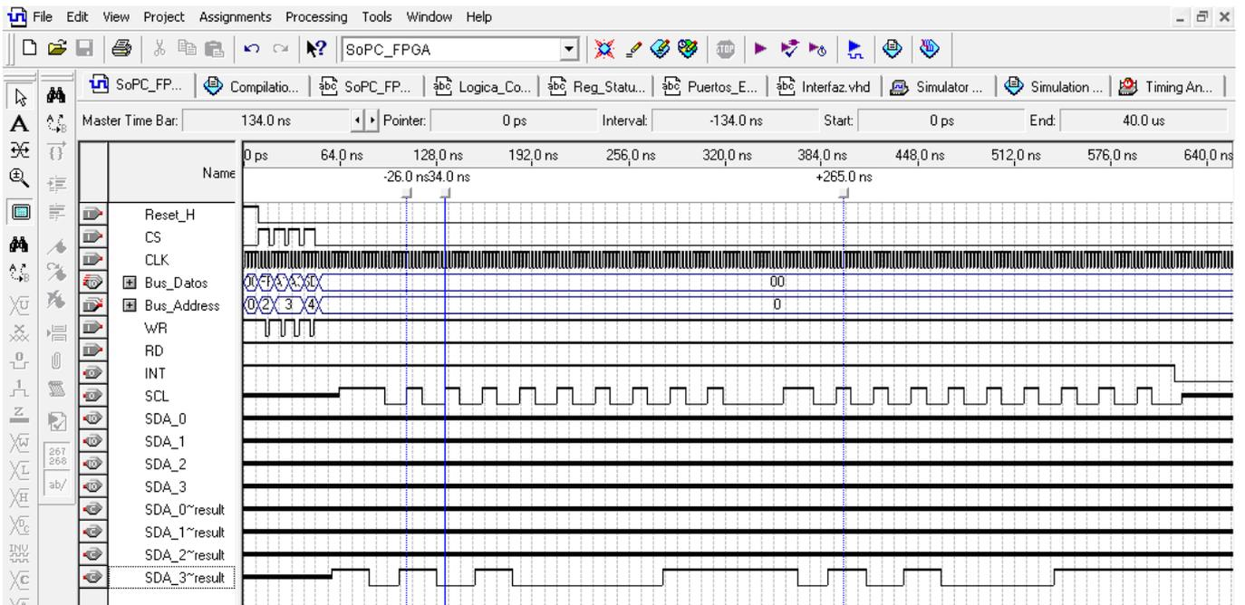
Figura 2 Resultado de la simulación del Módulo I2C master.
