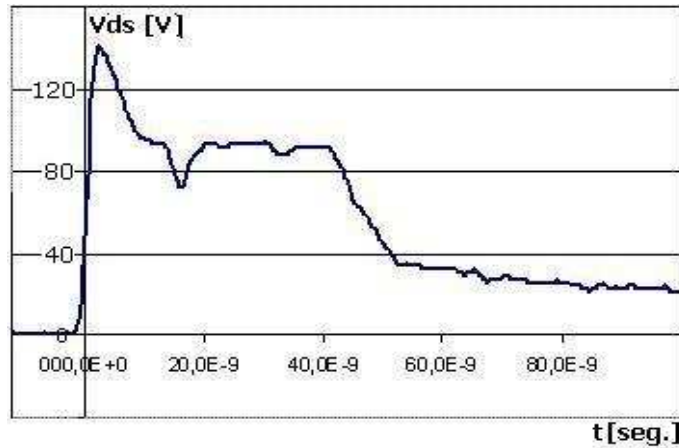
Figura 7. Detalle de V_{ds}(t) para pulsos de 200 ns
