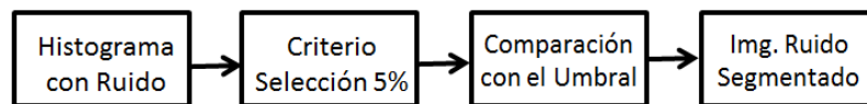
Figura 4. Diagrama en bloques del algoritmo del porcentaje utilizado para la segmentación de ruido.
