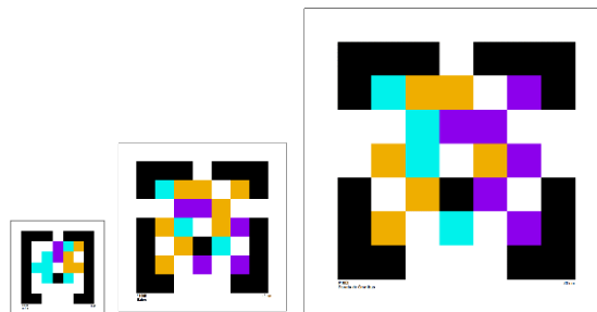
Figura 4 Ejemplos de marcadores para navegación, de 5, 10 y 20 centímetros
